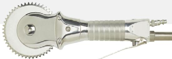
Пневматическая шкуроемная машина со звездообразными ножами
