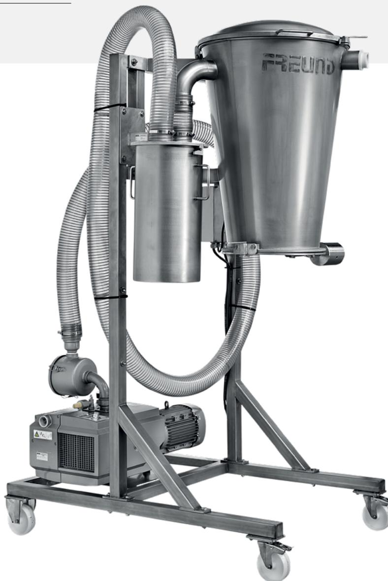
Вакуумная всасывающая система для удаления путём вакуумного всасывания спинного мозга, головного мозга, окологречного жира и остатков жира, лёгких у птицы и т. д. с помощью вакуума
