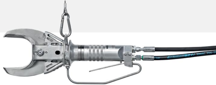
Ножницы для отделения шейной части и конечностей при разделке туш свиней и овец на промышленных предприятиях
