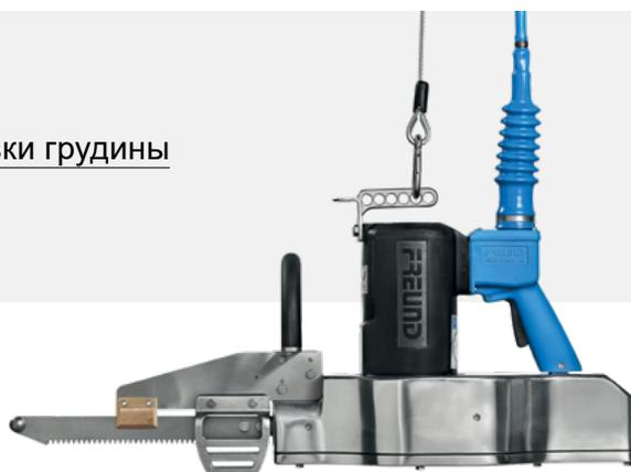
Приводная пила для распиловки грудины при разделке туш крупного рогатого скота и свиноматок на промышленных предприятиях
