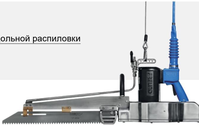
Приводная пила для продольной распиловки на полутуши до 100 туш свиней или до 20 туш крупного рогатого скота в неделю
