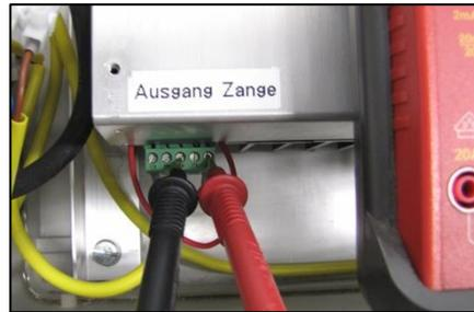
Abb. 9-5 Messung der Herzbetäubungsspannung
