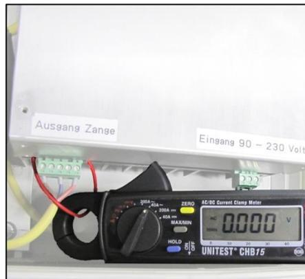
Abb. 9-1 Messung der Betäubungsstromstärke E6 und E8
