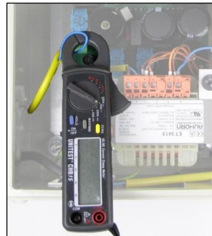
Abb. 9-2 Messung der Betäubungsstromstärke E4
