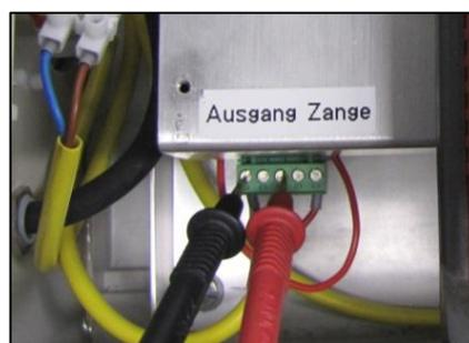
Abb. 9-3 Messung der Kopfbetäubungsspannung E6 und E8
