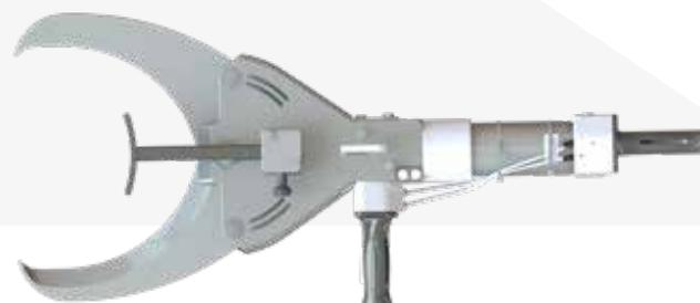
Hydraulische Nackenschere zum Nacken-Absetzen von Sauen & Ebern in Industriebetrieben
