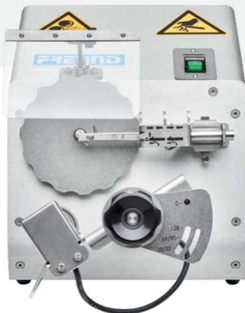
\*Figure : variante standard avec extracteur pour couteau Ø 69 -128mm
