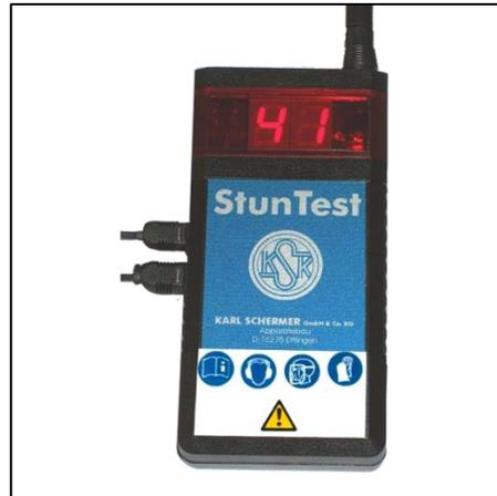
Fig.5-29 Visualización de la velocidad de salida
