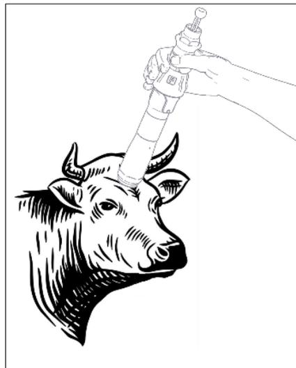
Fig. 5-30 Posición de aplicación del aturdidor de perno cautivo
