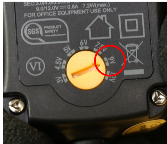
Abb.5-22 Einstellen der Spannungsversorgung
