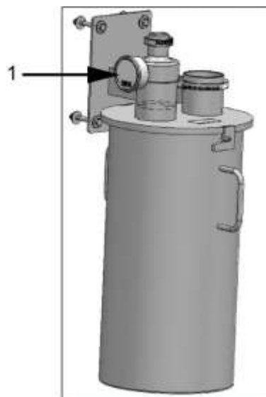
Abb. 3-9 Separatorkanne mit Manometer
