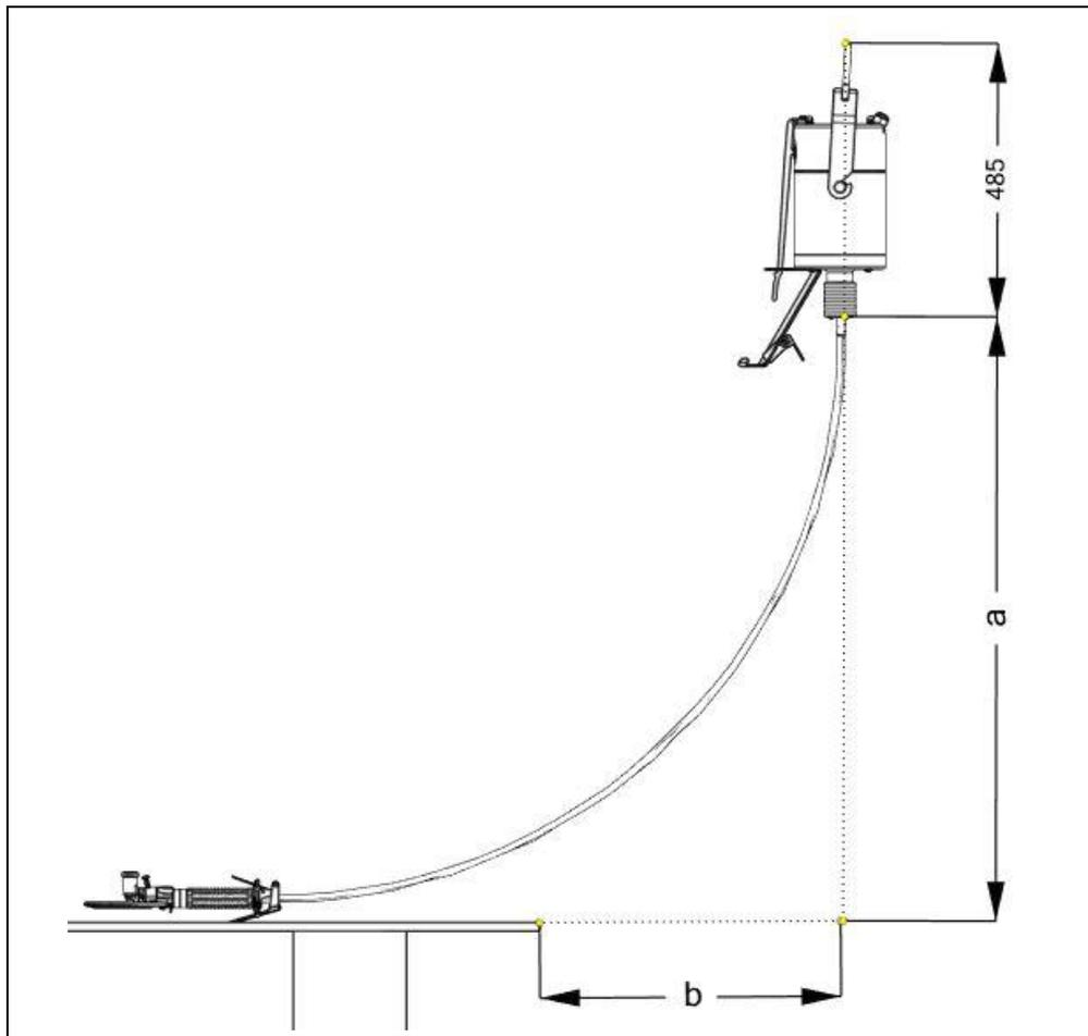
Fig. 5-1 Schéma de positionnement du moteur électrique
