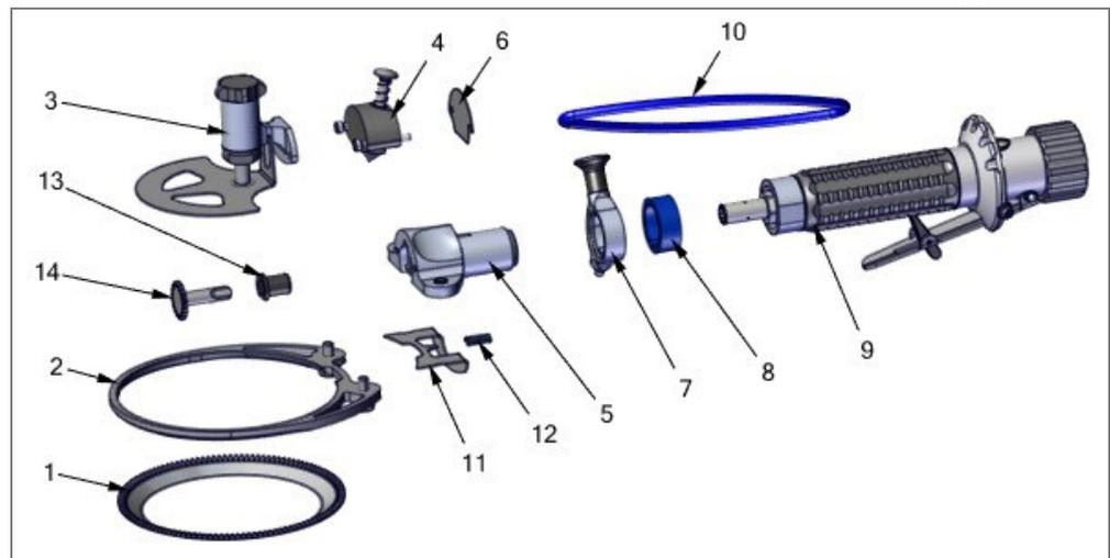
Abb. 3-5 Pneumatischer Trimmer 128\_evo3 (Beispiel)
