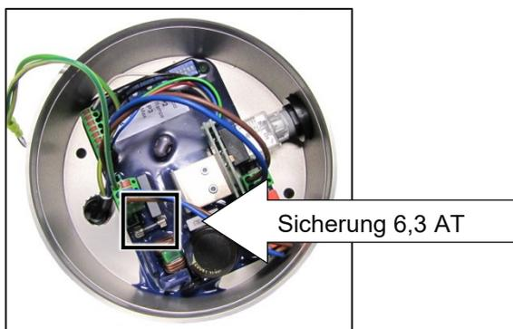
Abb. 8-1 Position der Sicherung
