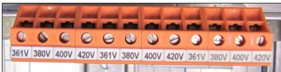
Rys. 5-12 Dodatkowe wejścia na inne napięcia
