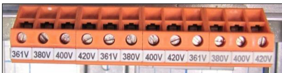
Fig. 5-12 Entrées supplémentaires pour autres tensions
