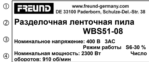
Рис. 3-13 Пример заводской таблички
