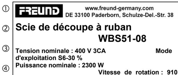
Fig. 3-13 Exemple de plaque signalétique
