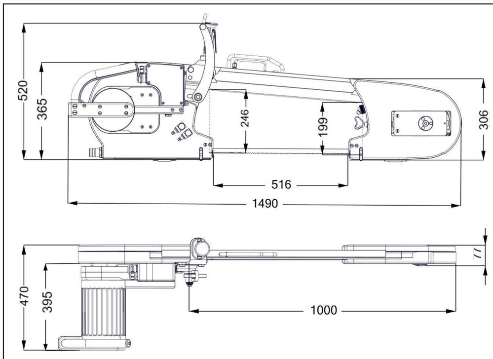
Abb. 3-3 Abmessungen WBS51-08 (Angaben in mm)
