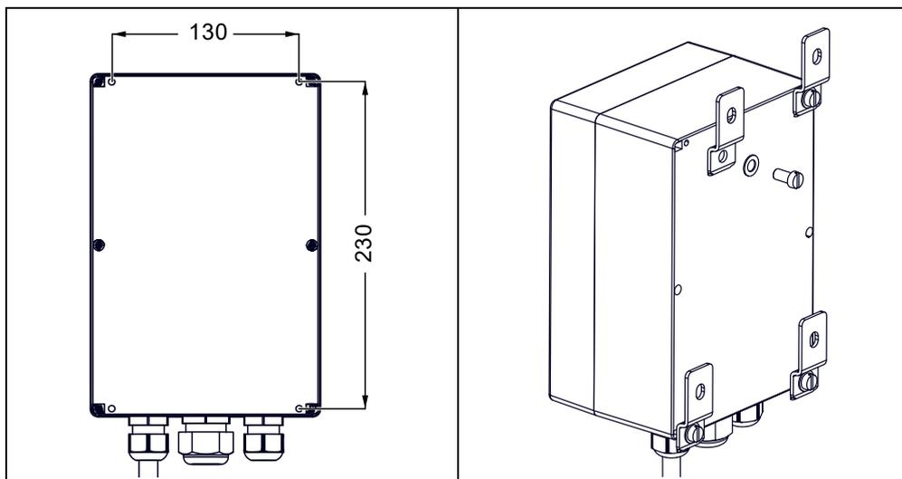
Abb. 5-4 Bohrbild Schaltgerät SG WBS51-08nc [Angaben in mm]
