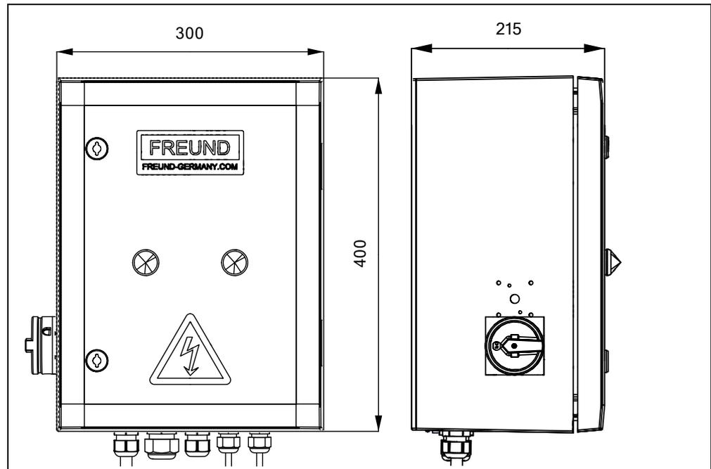
Abb. 3-10 Abmessungen Schaltgerät (Angaben in mm)
