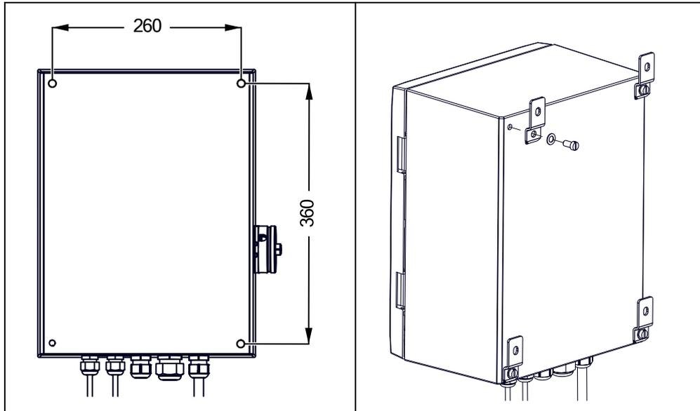
Abb. 5-2 Bohrbild Schaltgerät SG WBS51-08 [Angaben in mm]
