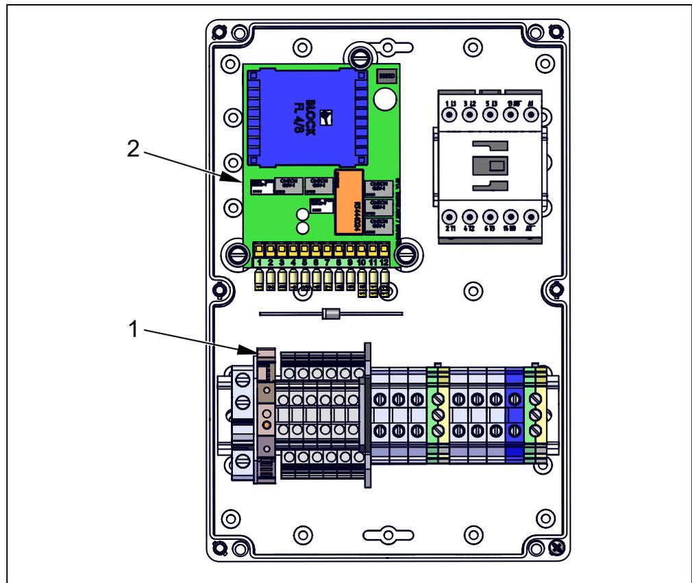
Abb. 9-2 LED-Statusanzeigen im Schaltgerät SG WBS51-08nc
