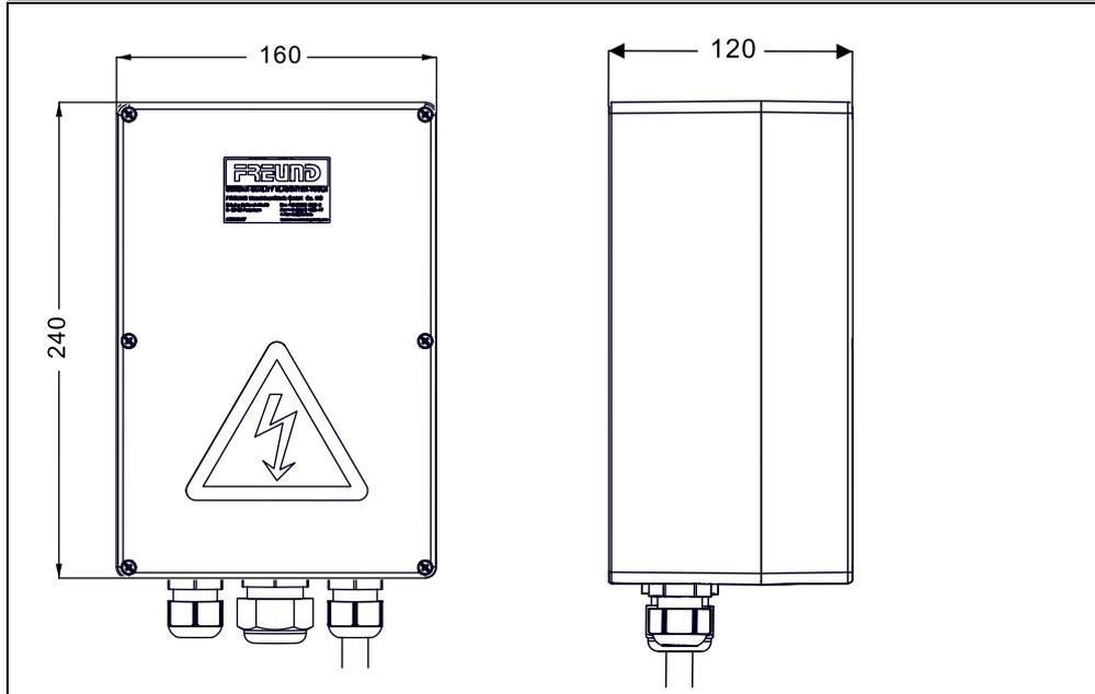
Abb. 3-12 Abmessungen Schaltgerät SG WBS51-08nc (Angaben in mm)
