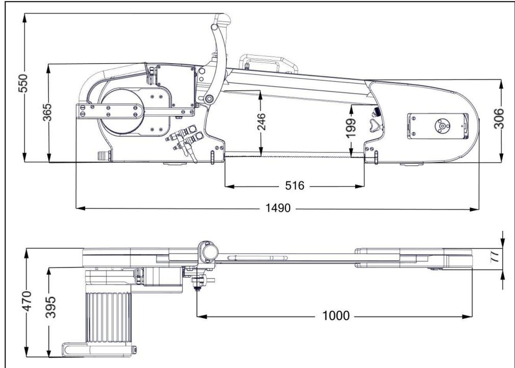
Abb. 3-7 Abmessungen WBS51-08nc (Angaben in mm)
