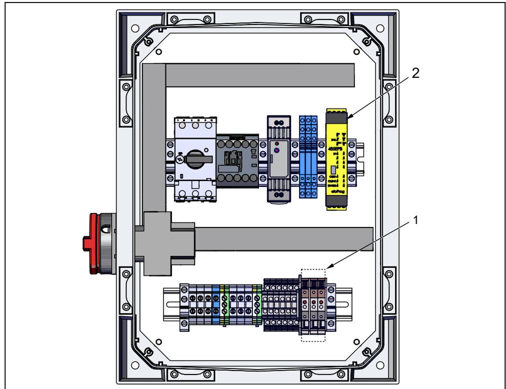
Abb. 9-1 LED-Statusanzeigen im Schaltgerät SG WBS51-08
