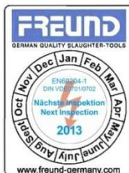
Die Wiederholungsprüfungen an ortsveränderlichen elektrischen Maschinen und Anlagen, die in Schlachthöfen und Zerlegebetrieben eingesetzt werden, müssen nach DIN VDE 0701-0702/EN 60204-1 alle sechs Monate durchgeführt werden.
