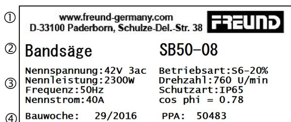
Abb. 3-7 Beispiel Typenschild auf der Stirnseite des Motors
