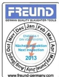
Die Wiederholungsprüfungen an ortsveränderlichen elektrischen Maschinen und Anlagen, die in Schlachthöfen und Zerlegebetrieben eingesetzt werden, müssen nach DIN VDE 0701-0702/EN 60204-1 alle sechs Monate durchgeführt werden.
