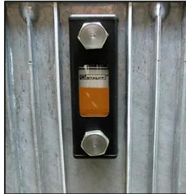
Abb. 8-1 Optimaler Öl-Füllstand
