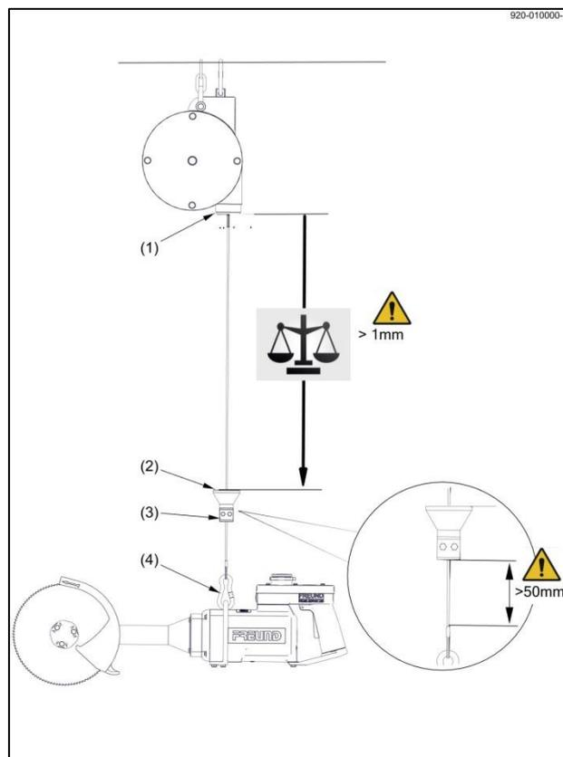
Рис. 5-1 Навешенная циркуляционная пила
