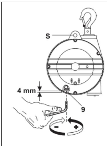
Рис. 5-2 Регулировка грузоподъемности
