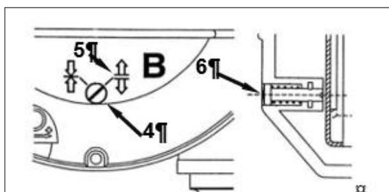
Рис. 5-5 Разблокировка барабана
