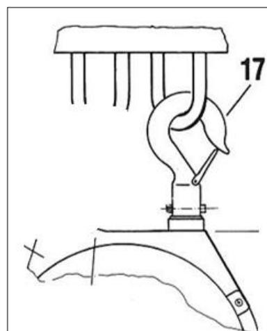
Рис. 4-2 Навешивание пружинного балансира
