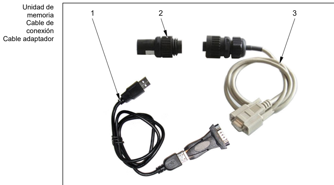
Imag. 3-13 Unidad de memoria, cable de conexión y cable adaptador
