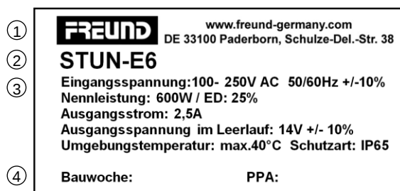
Рис. 3-4 Пример заводской таблички
