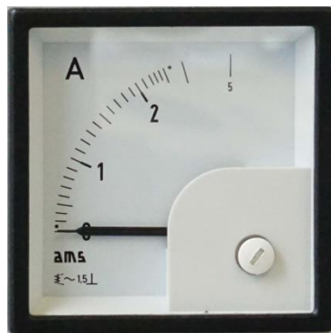
Fig. 5-5 Volt-visning med justeringsskrue nede til høyre
