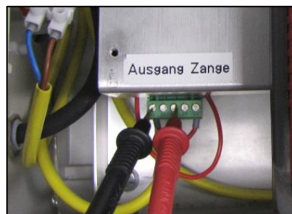
Fig. 9-3 Måling av hodebedøvingsspenning E6 og E8
