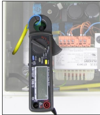
Fig. 9-2 Måling av bedøvingsstrømstyrke E4
