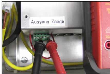
Afb. 9-5 Meting van de bedwelmingsspanning van de hart
