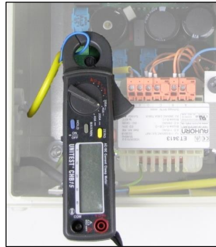
Afb. 9-2 Meting van de bedwelmingsstroomsterkte E4
