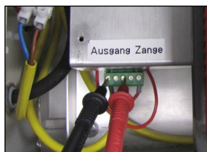
Afb. 9-3 Meting van de bedwelmingsspanning van de kop E6 en E8
