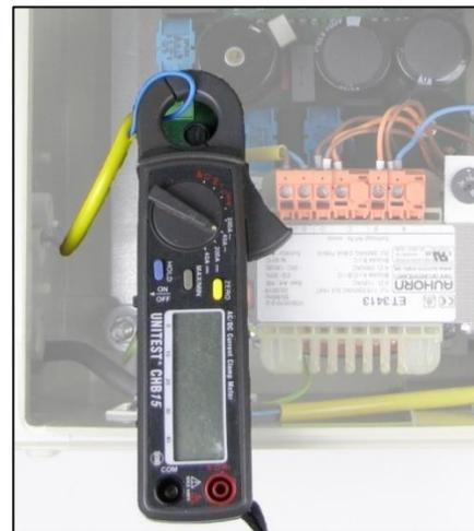
Fig. 9-2 - Misurazione dell'ampereaggio di stordimento E4
