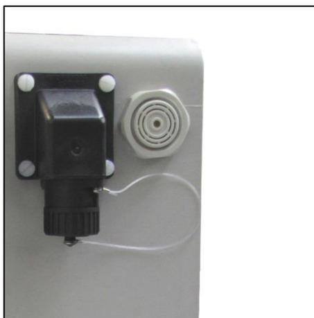
2. Inserire la spina (1) del cavo dati nel connettore dell'elettrostorditore.
