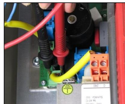
Fig. 9-4 - Misurazione della tensione di stordimento al capo E4
