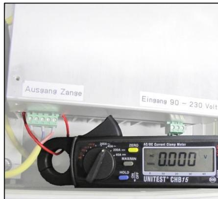
Fig. 9-1 - Misurazione dell'ampereaggio di stordimento E6 ed E8
