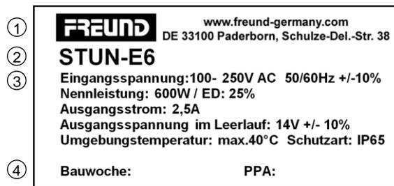
Fig. 3-4 Exemple de plaque signalétique
