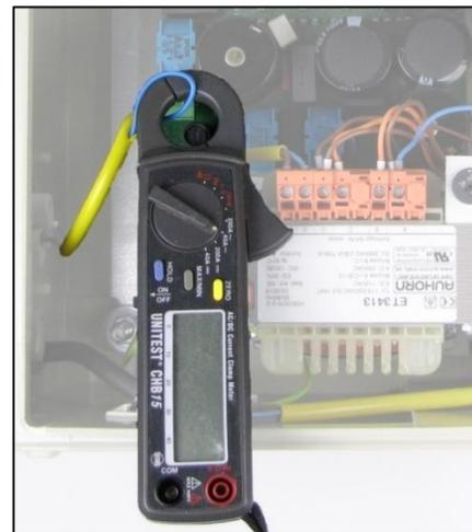
Abb. 9-2 Mesure de l'intensité du courant d'étourdissement E4
