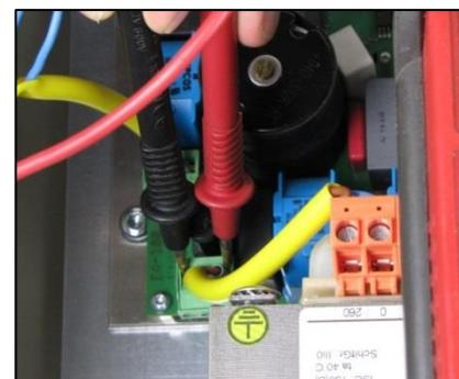
Fig. 9-5 Mesure de la tension d'étourdissement cérébral E4
