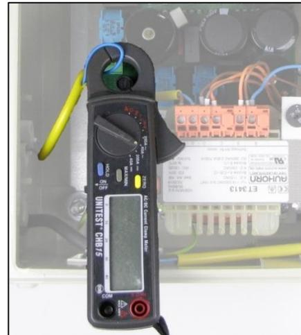
Imag. 9-2 Medición de la intensidad de corriente de aturdimiento E4
