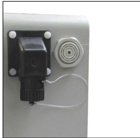
2. Introduzca el enchufe (1) del cable de datos en el conector del electro dispositivo de aturdimiento.
