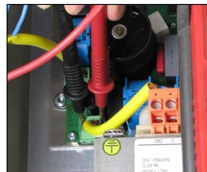
Imag. 9-4 Medición de la tensión de aturdimiento del cabezal E4
