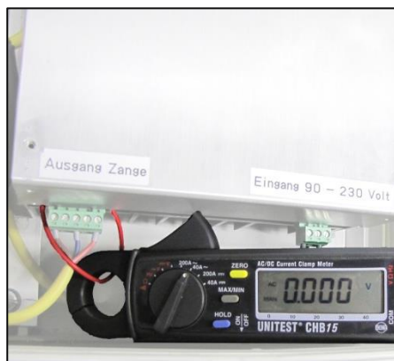
Fig. 9-1 Måling af bedøvelsesstrømstyrke E6 og E8
