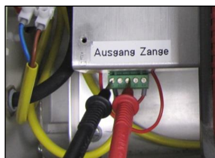
Fig. 9-3 Måling af hovedbedøvelsesspændingen E6 og E8
