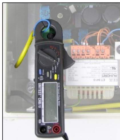
Fig. 9-2 Måling af bedøvelsesstrømstyrke E4
