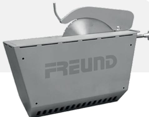
Serra circular com pedal para montagem lateral em sistemas de desmantelamento
